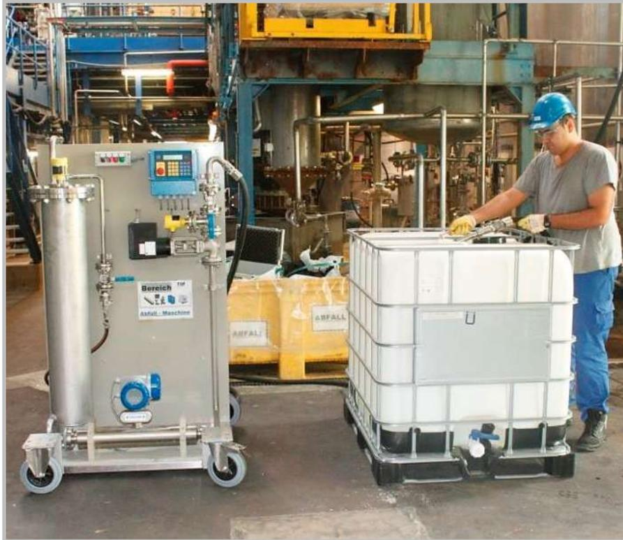
**Eichfähiges Abfüllsystem für IBC mit dem Krohne Massedurchflussmesser Optimass**
